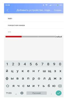
В случае успешного подключения будет запрос на добавление камеры. Затем ПО попросит внести новый пароль доступа от 6 до 30 знаков (буквы и цифры). После установки нового пароля можно подключиться к камере и получить изображение:
