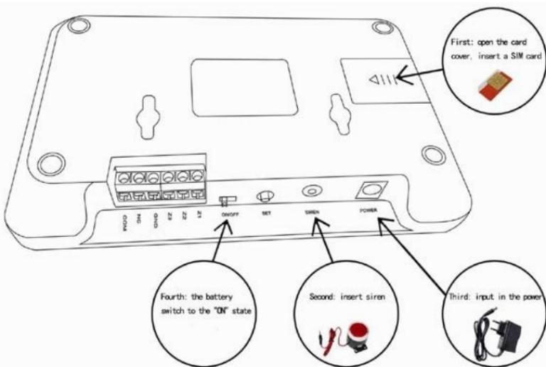
Внимание: Если пользователь включит устройство до того как вставит сим-карту в соответствующий слот, это может повлечь за собой выход устройства из строя. Во избежание этого сим-карту следует вставлять на выключенном устройстве.
